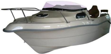
Das Modell für Angler und Liebhaber von Wasserfahrten funktioniert dank der geschlossenen Kabine mit Schlafplatz auch bei Kälte. Das Boot besteht aus einer Doppelschalenstruktur mit einem verstärkten Boden, ist mit einem Kotflügelstreifen ausgestattet (um ein Klopfen des Bootes zu verhindern). Das gesamte Zubehör des Bootes besteht aus hochwertigem säurebeständigem Stahl.
