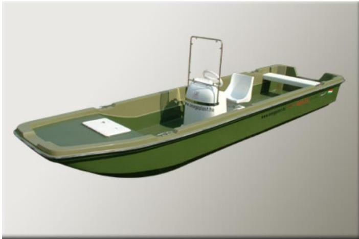
Flachboot mit Motor für 4 bis 5 Personen zum Angeln, Freizeit und Ausflug. Bodengestaltung wie bei Typ Shark, der Innenraum ist ästhetischer und kann leichter sauber gemacht werden, mit abschließbarer Schnabelabdeckung. Durch die niedrige Tauchtiefe kann sehr gut belastet werden, mit stabilem und geräumigem Innenraum.
