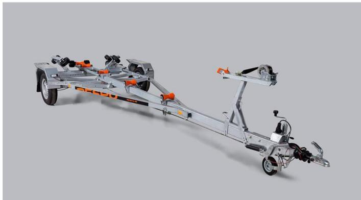
Kotflügel und andere Komponenten bestehen aus hochwertigem, mit Magnelis® beschichtetem Blech, das dreimal so korrosionsbeständig ist wie normales HDG. Mit dem hinteren Kipprahmen finden Sie den perfekten Winkel, um das Boot auf dem Anhänger und vom Anhänger abzurollen. Kielrollen zusammen mit einstellbaren Stützrollen helfen Ihnen, Ihr Boot sicher zu befestigen und geben Ihrem Boot auch gleichmäßigen Halt.
