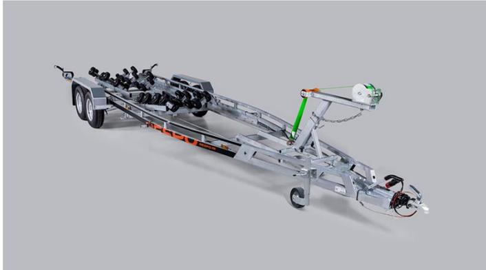
Innovativer Multirolleranhänger mit einem selbstregulierenden 36-Rollen-System, das ein gleichmäßigeres und sichereres Be- und Entladen gewährleistet. Sowie ein haltbarer HDG beschichteter geschweißter Stahlrahmen. Kotflügel und andere Komponenten bestehen aus hochwertigem, mit Magnelis® beschichtetem Blech, das dreimal so korrosionsbeständig ist wie normales HDG. Speziell entwickelte Trittschutzbleche bieten Ihnen mehr Funktionalität und Komfort.
