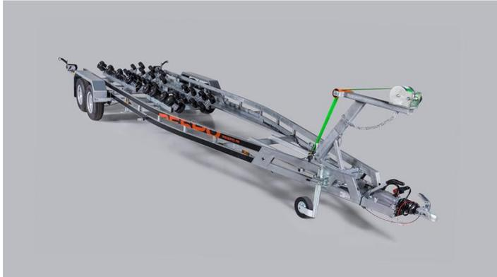
Innovativer Multirolleranhänger mit einem selbstregulierenden 44-Rollen-System, das ein gleichmäßigeres und sichereres Be- und Entladen gewährleistet. Sowie ein haltbarer HDG beschichteter geschweißter Stahlrahmen. Kotflügel und andere Komponenten bestehen aus hochwertigem, mit Magnelis® beschichtetem Blech, das dreimal so korrosionsbeständig ist wie normales HDG. Speziell entwickelte Trittschutzbleche bieten Ihnen mehr Funktionalität und Komfort.
