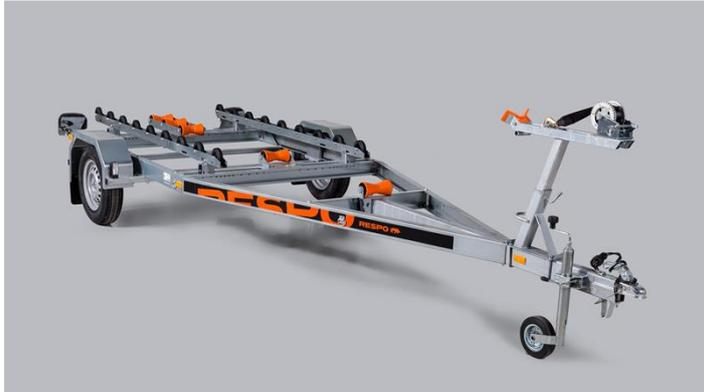
Kotflügel und andere Komponenten bestehen aus hochwertigem, mit Magnelis® beschichtetem Blech, das dreimal so korrosionsbeständig ist wie normales HDG. Mit wasserdichten Radnaben und Easyfold-Leuchten können Sie Ihren Anhänger teilweise auch im flachen Wasser verwenden.
