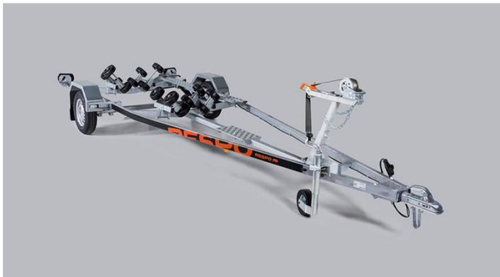
Innovativer Multirolleranhänger mit einem selbstregulierenden 16-Rollen-System, das ein gleichmäßigeres und sichereres Be- und Entladen gewährleistet. Sowie ein haltbarer HDG beschichteter geschweißter Stahlrahmen. Kotflügel und andere Komponenten bestehen aus hochwertigem, mit Magnelis® beschichtetem Blech, das dreimal so korrosionsbeständig ist wie normales HDG. Speziell entwickelte Trittschutzbleche bieten Ihnen mehr Funktionalität und Komfort.
