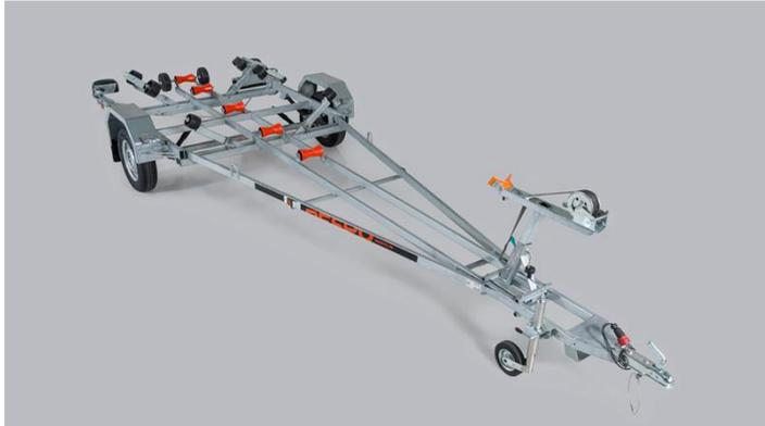
Robuster und langlebiger HDG-beschichteter geschweißter Stahlrahmen. Hergestellt aus Magnelis®-beschichtetem Blech, das dreimal so korrosionsbeständig ist wie normales HDG-Blech. Die doppelte Torsionsachse ist äußerst zuverlässig und bietet Ihnen eine bessere Stabilität auch in schwierigem Gelände. Der haltbare Sperrholzboden ist wasserdicht und rutschfest. Alle Bretter sind leicht zu öffnen und zu entfernen, so dass Sie den Anhänger bequem von allen Seiten beladen können.
