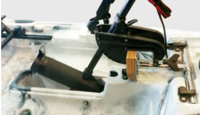
Bestehend aus: MINN KOTA Traxxis 45 Elektromotor mit einer um 15 cm teleskopiebaren Schalt- und Steuerpinne, die auch um 45° nach oben und unten geneigt werden kann.
