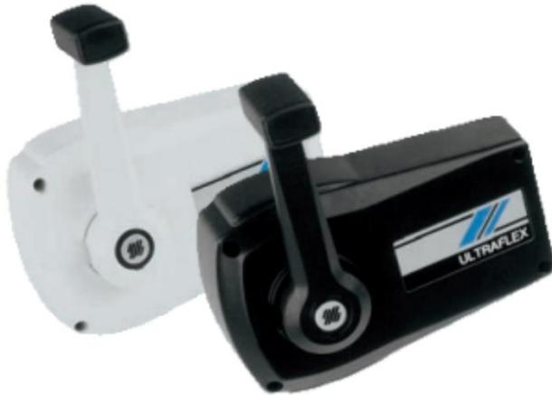
Ein Hebel für zwei Funktionen. Richtungsbestimmung und Geschwindigkeitsregelung in einem. Einsetzbar für alle Boote mit Außen- oder Innenborder oder Z-Antrieb. Die Montage kann an der Backbord- oder Steuerbordseite sowie horizontal oder vertikal erfolgen.
