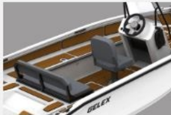
Auskleidung der Rumpffinnenwände mit rutschfestem EVA Marine Deck Material
