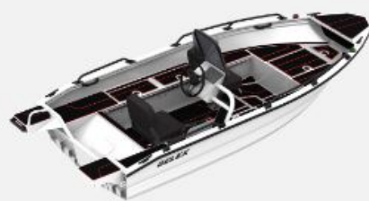
REMOTE-KONSOLE MIT WINDSCHUTZSCHEIBE UND FAHRERSITZ
