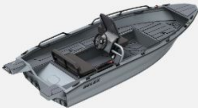
FERNSTEUERKONSOLE MIT WINDSCHUTZSCHEIBE UND SOFA IM HECKBEREICH
