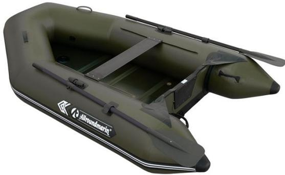
Dieses Kiwi 260 Sondermodell besitzt keine Bugrolle, jedoch ist der Heckspiegel mit PVC beschichtet und das Holz-Sitzbrett wurde gegen ein Carbon-Sitzbrett ausgetauscht. Das Boot wird je nach Modell mit Falt-Holzboden oder Hochdruckluftboden ausgeliefert. Ebenfalls ist es möglich die Ausstattung mit anderen Böden wie z.B. einen Aluminiumboden zu ergänzen.
