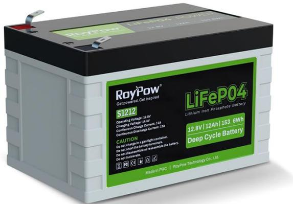
Diese Lithium (LiFePO4) Batterien sind wasserfest nach IP65, sehr stabil und sicher und haben eine sehr niedrige Selbstentladung. Sie haben einen Überladungs-, Entladungs-, Überhitzungs- und Kurzschlussschutz. Dieses Modell kann bis zu 4x in Serie und 2x Parallel geschaltet werden.
