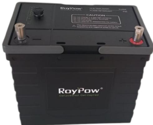
Diese Lithium (LiFePO4) Batterien sind wasserfest nach IP65, sehr stabil und sicher und haben eine sehr niedrige Selbstentladung. Sie haben einen Überladungs-, Entladungs-, Überhitzungs- und Kurzschlusschutz. Schraubpole müssen separat bestellt werden. Dieses Modell kann bis zu 4x in Serie und 4x Parallel geschaltet werden.
