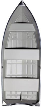
Das leichteste Boot der Strong-Serie besteht aus einer festen Aluminiumlegierung, die selbst gegen Meersalz beständig ist. Sein Design ermöglicht den Transport auf Autodächern. Der V-förmige Rumpf, die hohe Seite und das flache Heck sorgen für eine stabile Konstruktion und bieten auch bei Wellen hervorragende Eigenschaften.
