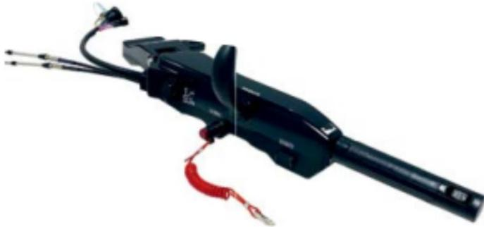
Die neue Multifunktionspinne ist bei allen MFS 25 C über den MFS 50 A bis zum MFS 140 A nachrüstbar. Sie verfügt über den ergonomischen angeordneten Trimm-/Tiltschalter, der vorn am Drehhandgriff montiert ist. So ist der Schalter bedienbar, ohne dass der Fahrer hinsehen muss.
