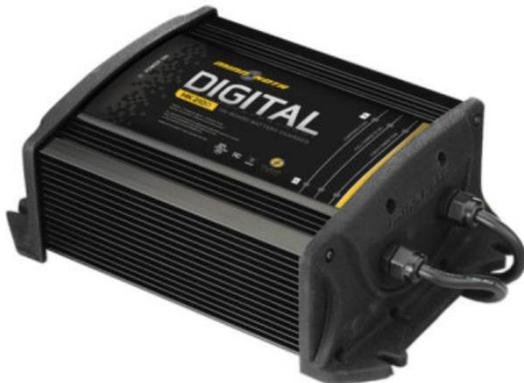
Die Minn Kota Onboard Ladegeräte sind mit zwei oder drei Ladeausgängen ausgestattet. Die Besonderheit liegt darin, dass jeder Ladeausgang eine eigene Masseleitung besitzt. Daher können auch Batterien, die z.B. auf 24V oder 36V in Serie geschaltet sind, ohne Auftrennung der Serienschaltung geladen werden.
