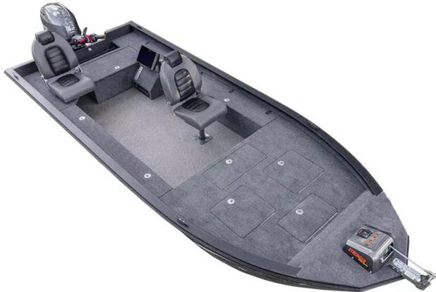
Das Powerboat 475 Tiller ist eine verlängerte Version des 420 Tiller und bietet mehr Platz im Cockpit und auf dem Bugdeck. Dank seiner Länge weist der Rumpf des 475 ausgezeichnete Laufeigenschaften auf, ohne dass ein leistungsstärkerer Motor erforderlich ist. Selbst ein sparsamer 25-PS-Motor reicht völlig aus.
