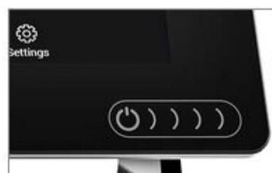
Robustes Vollglasdisplay optimiert zur flächenbündigen und Pultaufbau-Montage. Elegantes Design ohne Bedienknöpfe, einfaches Einschalten durch einen Streich mit dem Finger.
