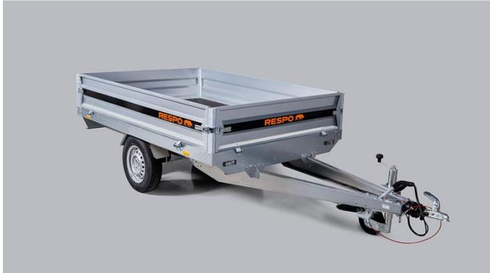
Der hochwertigste, innovative Anhänger mit monolithisch gebogenen Seitenwänden und superstarken HuckLok®-Schnittstellen. Hergestellt aus mit Magnelis® beschichtetem verzinktem Blech, das dreimal korrosionsbeständiger ist als standardmäßiges HDG-beschichtetes Blech. Zusätzlich zur Abdichtung ist das untere Sperrholz mit einer rutschfesten Beschichtung versehen. Die Seitenwände, Front- und Hecktüren sowie Eckpfosten lassen sich einfach öffnen und abnehmen.
