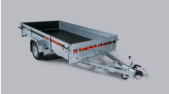
Super starker und langlebiger verzinkter geschweißter Rahmen. Ports und Fender mit erheblich hoher Tragfähigkeit bestehen aus verzinktem Blech mit Magnelis®-Beschichtung, das dreimal korrosionsbeständiger ist als standardmäßiges HDG-beschichtetes Blech. Starke 3-Blatt-Blattfedern, Stoßdämpfer, wasserdichte Naben sorgen für beste Fahreigenschaften und eine lange Lebensdauer.
