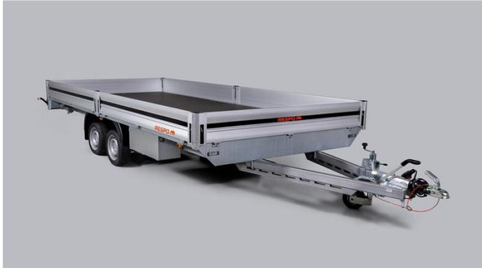
Der feuerverzinkte (HDG) Schweißrahmen bietet höchste Stabilität und Langlebigkeit. Leichte, aber robuste Aluminiumwände sowie vordere und hintere Klappe sorgen für Sicherheit. Die doppelte Torsionsfederung gewährleistet zuverlässige Stabilität, auch unter schwierigen Bedingungen. Die wasserfeste Sperrholz-Bodenplatte ist rutschfest beschichtet. Alle Seiten, einschließlich der Eckpfosten, sind leicht zu öffnen und zu entfernen, was ein einfaches Beladen ermöglicht.
