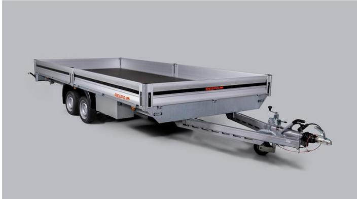
Der feuerverzinkte (HDG) Schweißrahmen bietet höchste Stabilität und Langlebigkeit. Leichte, aber robuste Aluminiumwände sowie vordere und hintere Klappe sorgen für Sicherheit. Die doppelte Torsionsfederung gewährleistet zuverlässige Stabilität, auch unter schwierigen Bedingungen. Die wasserfeste Sperrholz-Bodenplatte ist rutschfest beschichtet. Alle Seiten, einschließlich der Eckpfosten, sind leicht zu öffnen und zu entfernen, was macht das Laden einfach.
