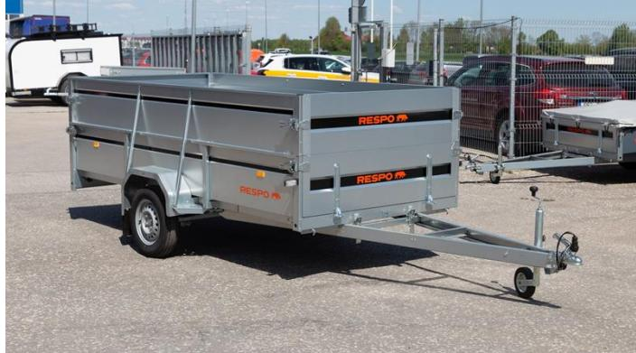
Die Bordwanderhöhungen mit einer hohen Lasttoleranz werden aus heißverzinktem Magnelis® Blech mit einer Schutzschicht hergestellt, dies gewährleistet ihnen ein langes Leben. Die beste Lösung, um das Volumen des Anhängers zu verdoppeln. Bei einem Anhänger mit Erhöhungen kann auch noch ein Deckel angebracht werden. Das Erzeugnis eignet sich für Respo Anhänger.
