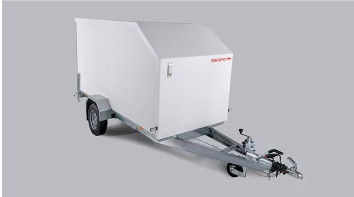
Ein äußerst langlebiger und wetterfester Transporteranhänger mit einem schlanken und aerodynamischen Design zur Minimierung des Windwiderstands. Die Wände werden aus 25 mm Sandwichelementen hergestellt. Hergestellt aus Magnelis®-beschichtetem Blech, das dreimal so korrosionsbeständig ist wie normales HDG-Blech. Hochwertige Blattfederachsen, wasserdichte Radnaben und Stoßdämpfer garantieren ein reibungsloses Handling und eine lange Lebensdauer.
