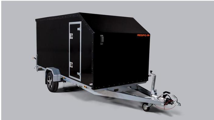
Extrem langlebiger und wetterfester Kofferanhänger, die Wände bestehen aus 25-mm-Sandwichplatten. Die Metallkomponenten bestehen aus Magnelis®-beschichtetem verzinktem Blech, das dreimal korrosionsbeständiger ist als standardmäßiges HDG-beschichtetes Blech. Starke 4-Blatt-Blattfedern, Stoßdämpfer, wasserdichte Naben organ für beste Fahreigenschaften und eine lange Lebensdauer.
