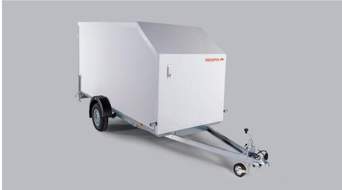
Extrem langlebiger und wetterfester Kofferanhänger, die Wände bestehen aus 25-mm-Sandwichplatten. Die Metallkomponenten bestehen aus Magnelis®-beschichtetem verzinktem Blech, das dreimal korrosionsbeständiger ist als standardmäßiges HDG-beschichtetes Blech. Starke 4-Blatt-Blattfedern, Stoßdämpfer, wasserdichte Naben sorgen für beste Fahreigenschaften und eine lange Lebensdauer.
