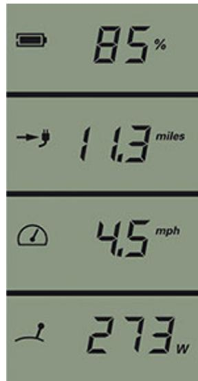
**Bordcomputer mit GPS basierter Reichweitenberechnung,**
