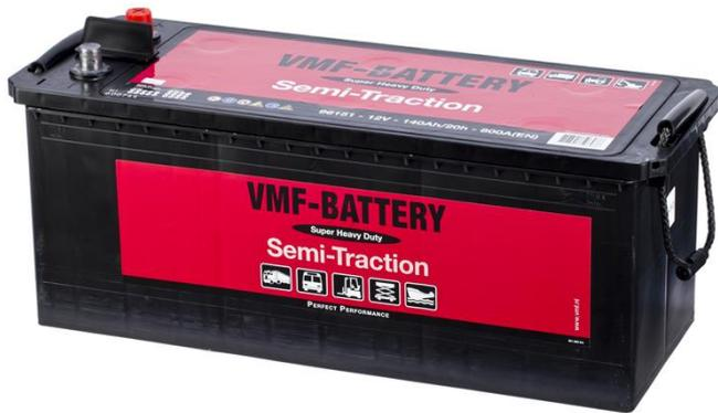
Diese Blei/Säure Verbraucherbatterie ist komplett wartungsfrei. Es ist ein SMF System und deswegen besitzt es ein geschlossenes Gehäuse und muss nie nachgefüllt werden. Ein Überdruckventil ist vorhanden. Ebenfalls sind die Plus und Minus Pole im Lieferumfang enthalten. Lebensdauer: ca. 350 Ladezyklen bei 50% Entladung.
